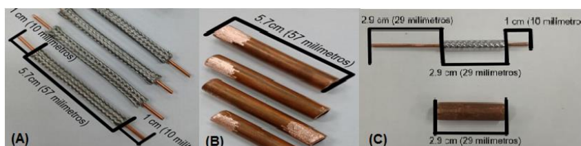
Figura 13: Cabo coaxial, Cano de Cobre e Extremidade da Antena
